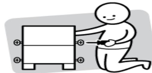
No apriete completamente todos los tornillos hasta que finalice el proceso en cada paso.
